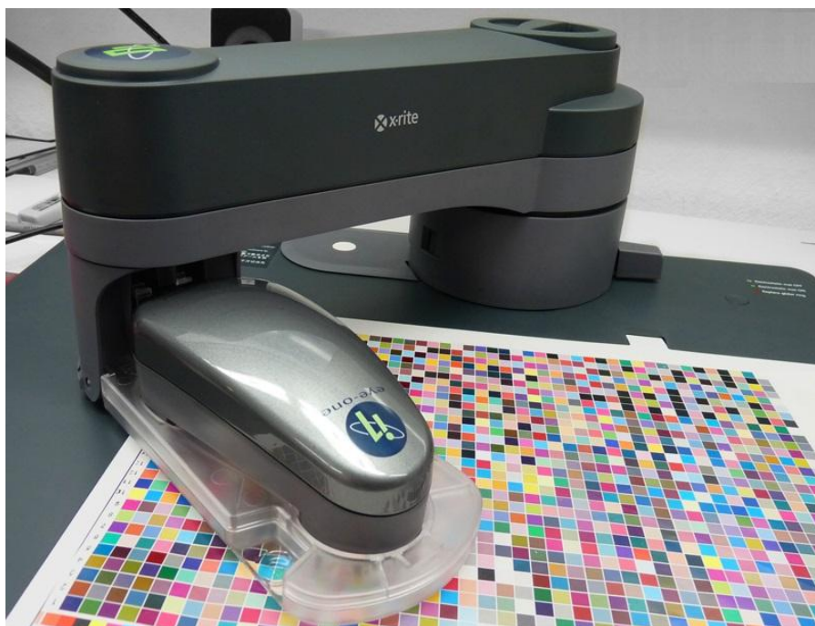
4.10 ábra. A modellparaméterek meghatározására nagyszámú mérést kell végezni, a modern műszertechnika lehetővé teszi az automatikus pozicionálást a tesztábrán
