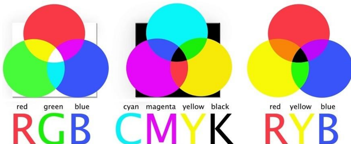
3.1 ábra. Az additív színkeverés (bal oldalon) tipikus alapszínei a vörös (red, R), zöld (green, G) és a kék (blue, B), a szubtraktív színkeverés alapszínei nyomtatás esetén (középen) a cián (cyan, C), bíbor (magenta, M), sárga (yellow, Y) és technológiai okokból a fekete, viszont a festészetben (bal oldalon) festék alapszíneknek a vöröset, sárgát és kéket használják
